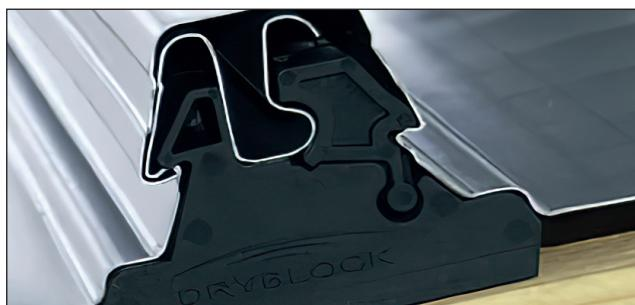
La particularité exclusive du système Drytec® est l'accrochage à chevauchement sur toute la longueur de l'onde, ce qui optimise les caractéristiques mécaniques du profil (portée et résistance à l'eau). Pour l'application des accessoires (modules photovoltaïques, retenues de neige et systèmes antichute), il faut prévoir l'utilisation du support de fixation Multiblock qui permet, sans perçage, l'installation des composants supplémentaires.
