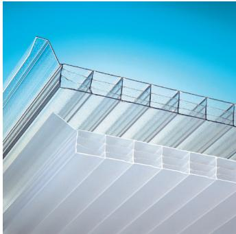
Système modulaire plat avec extrémités nervurées en polycarbonate alvéolaire conçu pour la réalisation de lanternes et de couvertures transparentes plates associées à des panneaux nervurés en application individuelle. Il est caractérisé par un recouvrement nervuré latéral vertical particulier et par une forte planéité.
