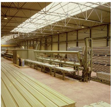
Photo d'archives: intérieurs de l'usine Isolpack de Villanova d'Asti, 1972. La première ligne en continu pour la production de panneaux réalisée en Italie.
